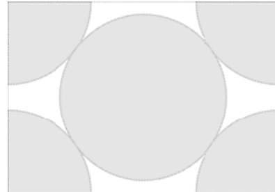
Figur 1b) (110)- plan i ei kubisk enhetscelle fra en BCC-struktur
