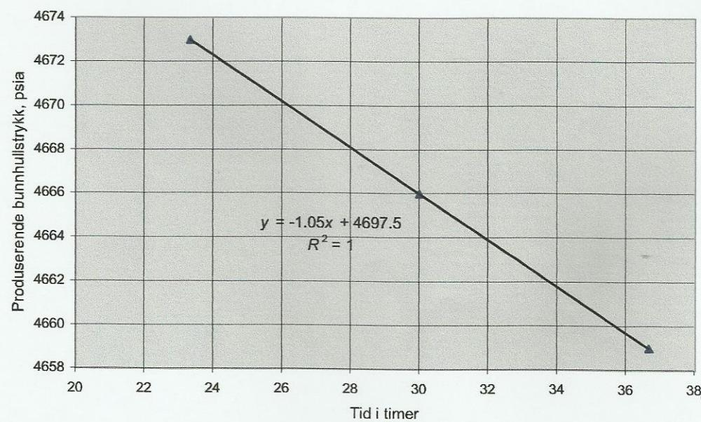
Figur 2: Trykkfallstest,  $p_{wf}$  som funksjon av tiden i timer etter ratestart, halvstasjonær periode, oppgave 1
