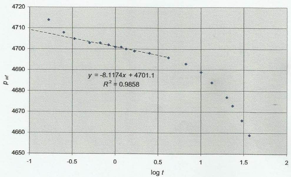
Figur 1: Trykkfallstest,  $p_{wf}$  som funksjon av logaritmen til tiden i timer etter ratestart, “infinite-acting period,” oppgave 1.
